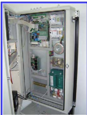
Electronique à l'arrière du boîtier, isolé de la partie humide
