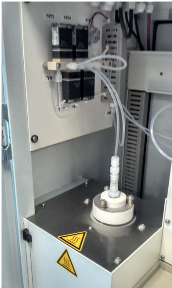
Détails des vannes et du port d'injection
