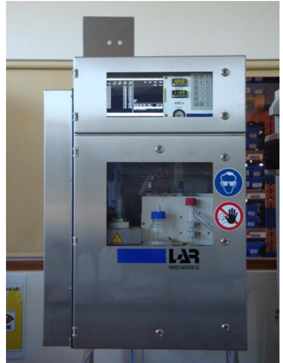
Suivi d'eau souterraine Boîtier INOX
