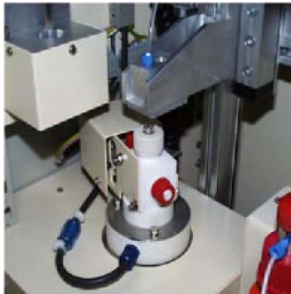
Détails de la vanne d'injection, du port d'injection et du système X-Y
